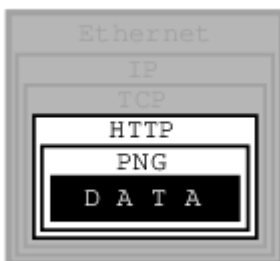
Рисунок 2. Уровни протоколов, покрываемые сокетами
